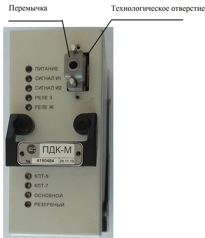
Рисунок 3.2 – Установка перемычки для снятия защитного состояния ПДК-М
