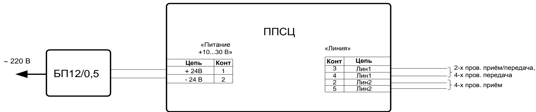
Рисунок Б.1 - Схема включения ППСЦ с питанием от БП12/0,5 и без защиты линий связи
