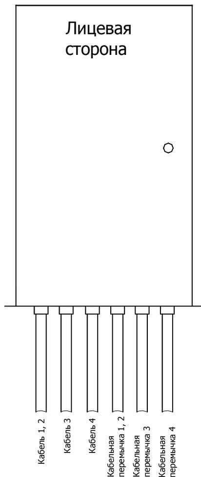
Кабель 1, 2 – основной и резервный фидер питания, вход аппаратуры защиты;
