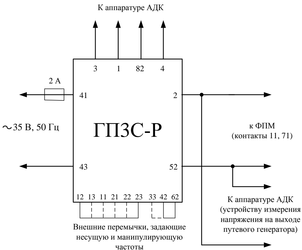
Рисунок 1 – Схема включения генератора ГПЗС-Р
